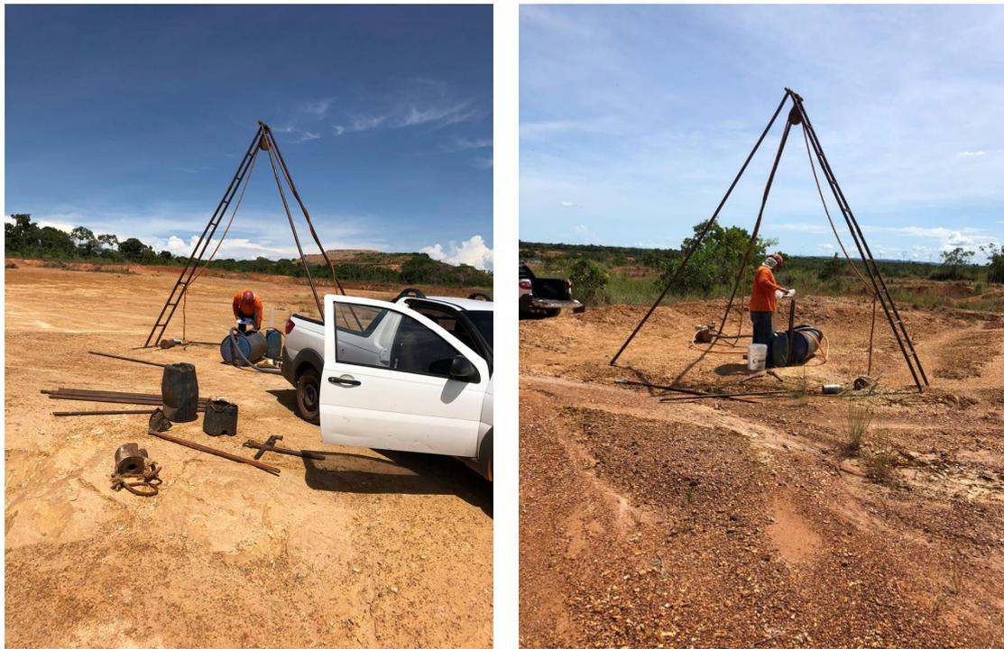
Execução dos furos de sondagens e ensaios de infiltração de água no solo
