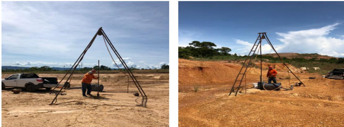
Execução dos furos de sondagens e ensaios de SPT
